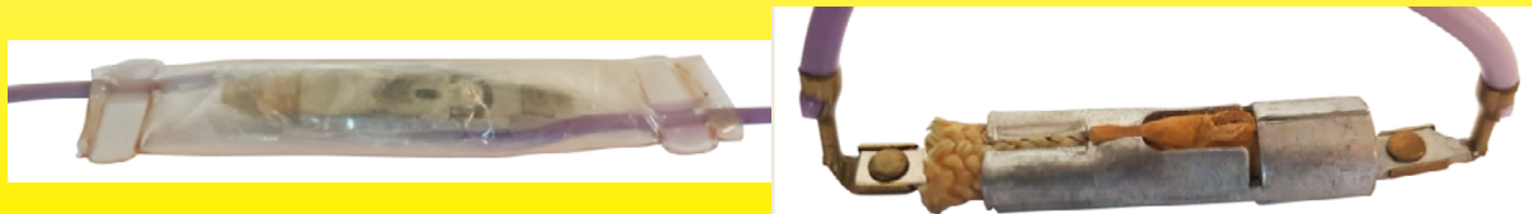
Limiteur de température de couverture chauffante, à rupture lente, utilisé conjointement avec un système de régulation de puissance anglais GEC (General Electric Company). Il est recouvert d'un manchon PVC étanche soudé sur les fils. Vers 1970 (Collection Ultimheat)
