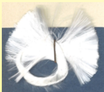
Faisceau de brins de silionne formant un fil simple (Fabrication du silionne, vers 1960, cours de l'école textile de Verviers en Belgique, Musée Ultimheat)
