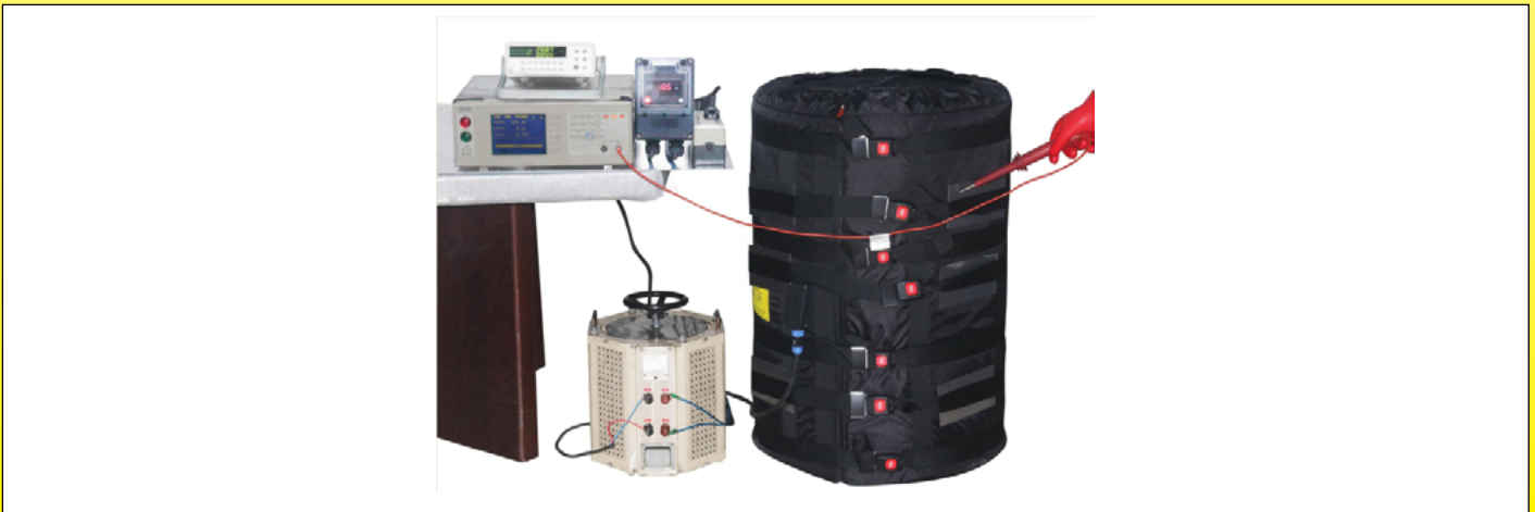
Dispositif d'essai de mesure du courant de fuite à chaud
