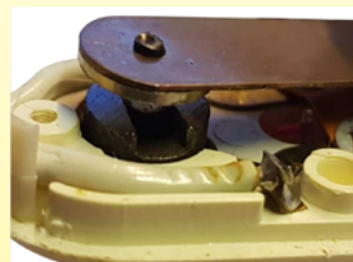
1972 ca Boitier de réglage de la puissance réalisé par Jidé à Limoges sous la marque Jidéstat. Le plus abouti de tous les systèmes. De très faible dimensions, il est réglable, et incorporé dans la fiche électrique. C'est le seul modèle comportant un contact à rupture brusque par aimant. Il ne sera pas surpassé par les systèmes électromécaniques développés jusqu'à nos jours. (Collection Ultimheat)
