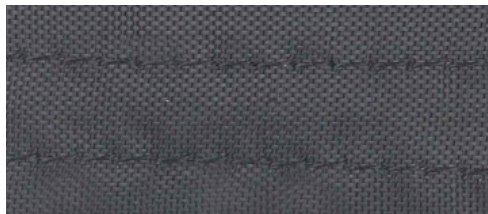
96 heures à 120°C sur le câble chauffant : aucun changement de couleur, aucune fusion d'isolant, aucune modification des caractéristiques
