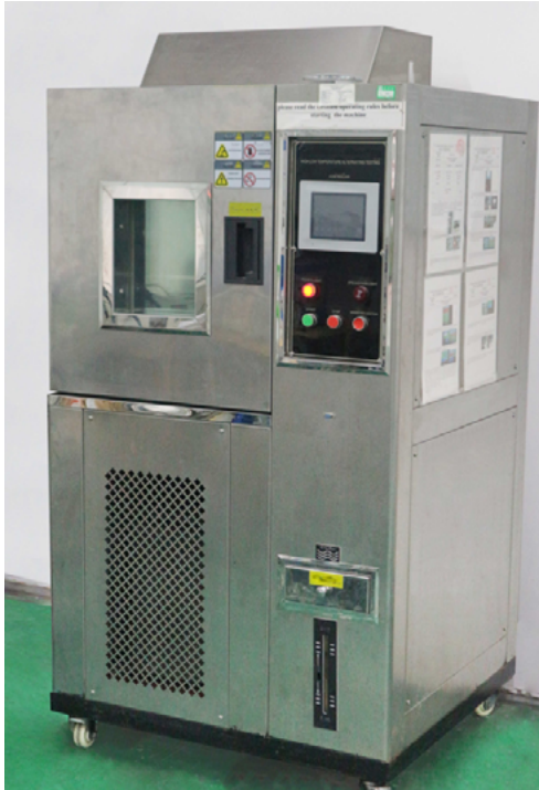
Enceinte climatique, avec plage de réglage de température de -90à +150°C, plage de réglage d'humidité relative 1 à 100%
