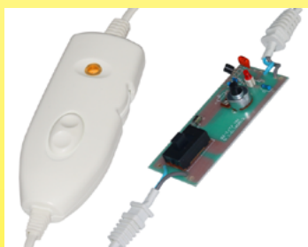
2019 Boitier de commande de couvertures chauffantes à réglage de puissance électronique continu (Collection Ultimheat)
