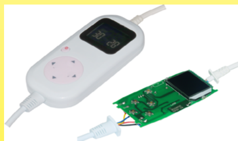
2019 Boitier de commande de couvertures chauffantes à réglage de température à affichage digital par une sonde à thermistance incorporée dans la zone chauffante (Collection Ultimheat)
