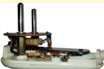
1972 ca Boitier de réglage de la puissance réalisé par Jidé à Limoges sous la marque Jidéstat. Le plus abouti de tous les systèmes. De très faible dimensions, il est réglable, et incorporé dans la fiche électrique. C'est le seul modèle comportant un contact à rupture brusque par aimant. Il ne sera pas surpassé par les systèmes électromécaniques développés jusqu'à nos jours. (Collection Ultimheat)
