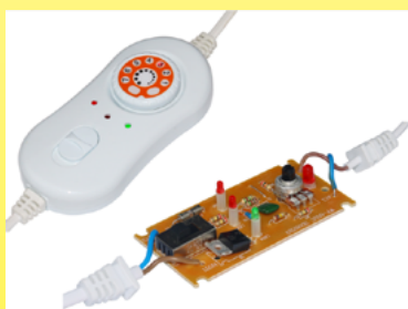
2019 Boitier de commande de couvertures chauffantes à réglage de puissance électronique continu (Collection Ultimheat)
