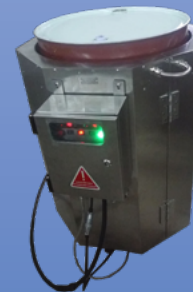
Etuves rigides enveloppantes, pour chauffage rapide de fûts par infra-rouge
