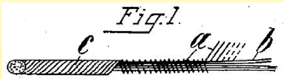
Corde chauffante (brevet Camille Herrgott, 1901). A= fil chauffant ; B= âme textile ; C= guipage extérieur bobiné en sens inverse du fil chauffant
