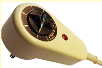
1972 ca Boitier de réglage de la puissance réalisé par Jidé à Limoges sous la marque Jidéstat. Le plus abouti de tous les systèmes. De très faible dimensions, il est réglable, et incorporé dans la fiche électrique. C'est le seul modèle comportant un contact à rupture brusque par aimant. Il ne sera pas surpassé par les systèmes électromécaniques développés jusqu'à nos jours. (Collection Ultimheat)
