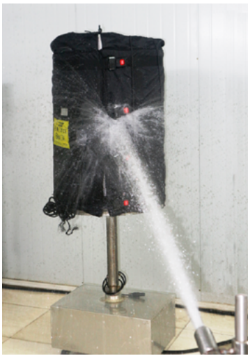
Essais IPx6 des couvertures chauffantes
